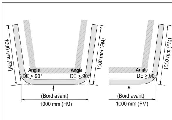
Raccord d'angle (DE) sans angle droit  $\neq 90^\circ$ , angle extérieur. Mesure d'angle à fournir impérativement.
