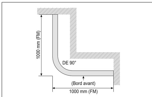
Raccord d'angle (DE) angle extérieur
