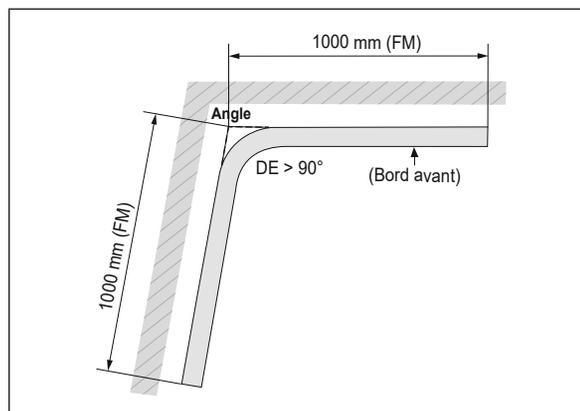
Raccord d'angle (DE) sans angle droit  $\neq 90^\circ$ , angle intérieur. Mesure d'angle à fournir impérativement.
