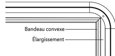
Afin de faciliter le transport et le montage, nous livrons les rails pour bow-window sans bandeau avec raccord. Le raccord des rails avec bandeau qui ont deux sections de rail supérieures à 2000 mm s'effectue au niveau du raccord d'angle (en standard). Les rails dont la longueur de bandeau est supérieure à la longueur de bandeau max. (v. p. 22) sont fournis avec un raccord de bandeau et de rail au centre (en standard).
