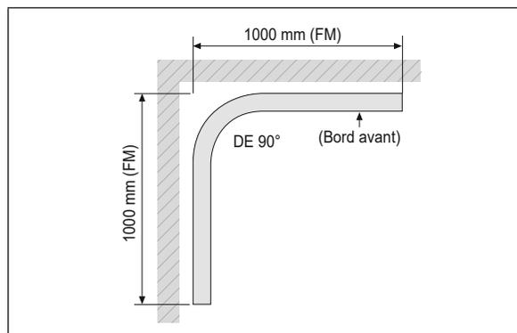
Raccord d'angle (DE) angle intérieur
