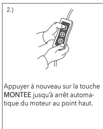
Appuyer à nouveau sur la touche MONTEE jusqu'à arrêt automatique du moteur au point haut.
