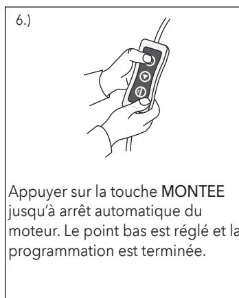
Appuyer sur la touche MONTEE jusqu'à arrêt automatique du moteur. Le point bas est réglé et la programmation est terminée.
