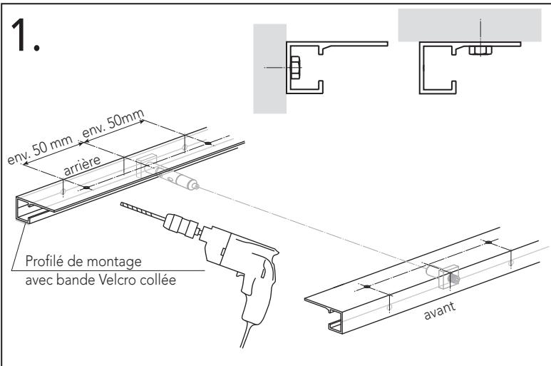
Compte tenu de l'importante force de traction, le profilé de montage doit être vissé à l'endroit précis de la structure porteuse où se trouvent les câbles de guidage. Pour un résultat optimal, il convient d'effectuer la fixation à l'aide de 2 vis placées aussi près que possible (env. 50 mm) à gauche et à droite du câble de guidage.
