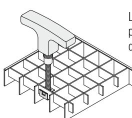
L'outil de positionnement 17 33 60 permet un montage par le haut, sans devoir démonter la grille.
