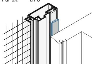
Veuillez noter que sur des surfaces inappropriées (par ex. humides, vernis pour bois problématique) ou dans des conditions extérieures extrêmes (par ex. fond sombre + côté soleil), la bande magnétique autocollante risque de se décoller. (pas de garantie d'adhérence longue durée)
