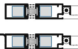
En présence d'une exposition au vent élevée, la force magnétique est renforcée en insérant d'autres aimants (Équipements supplémentaires PF2).
