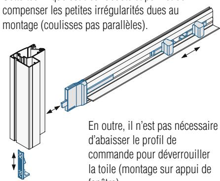
En outre, il n'est pas nécessaire d'abaisser le profil de commande pour déverrouiller la toile (montage sur appui de fenêtre).
