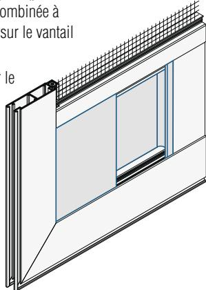
Sur demande, il est également possible de réaliser une plinthe avec raccord pour traverse et sans coupelle de commande au pied.
