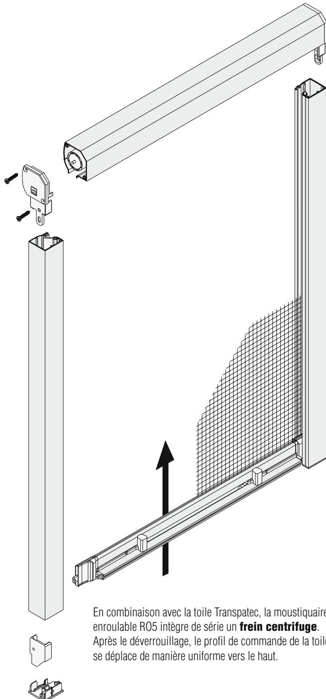
En combinaison avec la toile Transpatec, la moustiquaire enroulable R05 intègre de série un **frein centrifuge**. Après le déverrouillage, le profil de commande de la toile se déplace de manière uniforme vers le haut.
