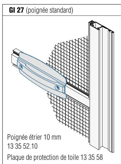
Si la poignée sur la porte de balcon / terrasse entrave le cadre moustiquaire, elle peut être remplacée par une poignée de montage extrêmement plate (voir chapitre Matériel nécessaire au montage).
