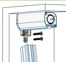
Ceci permet par ex. de monter la moustiquaire enroulable sans problème entre la fenêtre et les coulisses du volet roulant (encombrement 40 mm).
