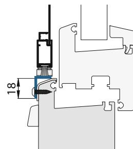
gris argenté anodisé : sur demande, la cornière inférieure peut être exécutée dans les dimensions 30 x 15 mm et 20 x 15 mm en gris argenté anodisé (E6/EV1 mat).
