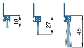
Le trou oblong permet de régler la hauteur du profilé en H 10 35 61 de max. 6,5 mm.
