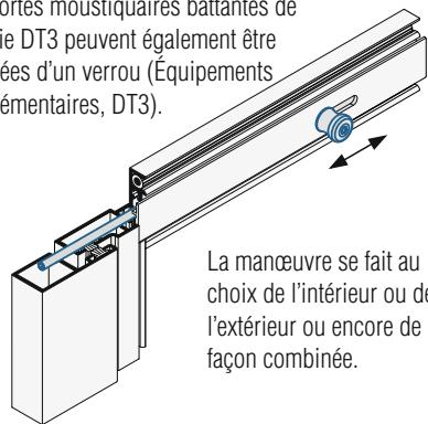
La manœuvre se fait au choix de l'intérieur ou de l'extérieur ou encore de façon combinée.
