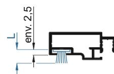
**La longueur indiquée pour le joint-brosse (L)** correspond à la hauteur totale de la brosse en mm, avec le dos. En insérant la brosse dans le canal prévu à cet effet, la hauteur visible de la brosse est réduite d'env. 2,5 mm.
