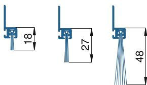
Le trou oblong permet de régler la hauteur du profil en H 10 35 61 de max. 6,5 mm.
