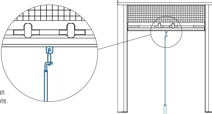
Le profil de commande de la toile peut également être équipé d'un cordon (500 mm) comme simple alternative à la tige de manœuvre.
