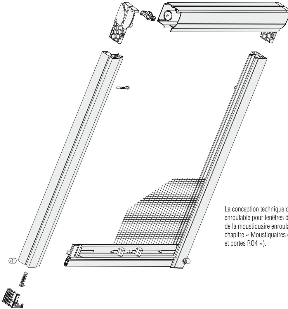
La conception technique de la moustiquaire enroulable pour fenêtres de toit correspond à celle de la moustiquaire enroulable pour fenêtres (voir chapitre « Moustiquaires enroulables pour fenêtres et portes R04 »).
