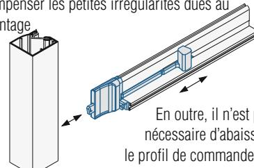
En outre, il n'est pas nécessaire d'abaisser le profil de commande pour déverrouiller la toile (montage sur appui de fenêtre).
