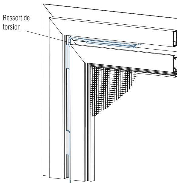
Le fonctionnement du ferme-porte est assuré par un ressort de torsion. Cela signifie que l'on dispose de davantage de force de fermeture que nécessaire. Le fonctionnement peut cependant être perturbé par un vent très fort ou par un frottement accru du joint-brosse sur le sol.
