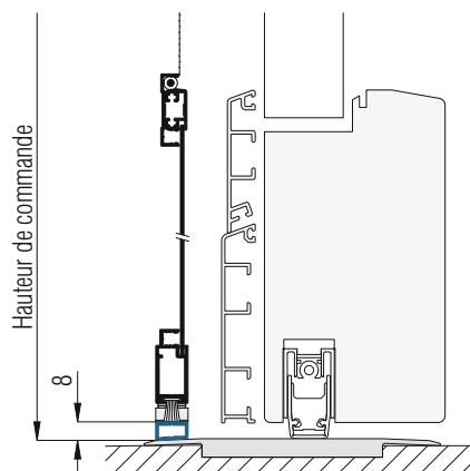
Pour les variantes de portes moustiquaires va-et-vient avec profilé de cadre 10 34 22 en bas, un système de drainage peut être intégré sur demande.
