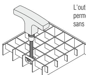
L'outil de positionnement 17 33 60 permet un montage par le haut, sans devoir démonter la grille.
