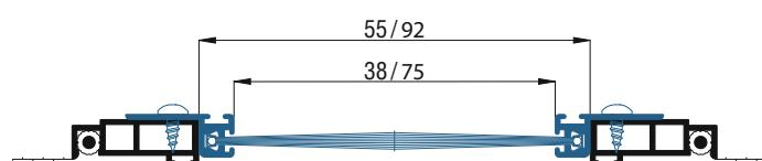
Les évidements (par ex. pour le dispositif automatique d'ouverture de fenêtre) sont étanchéifiés par un profilé en H avec brosse strip.
