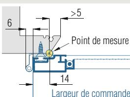
**En cas de recouvrement de dormant très incliné (> 5 mm), utiliser un autre point de mesure :**
