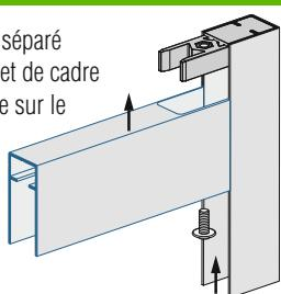
Ceci permet par ex. de monter la moustiquaire plissée sans problème entre la porte (fenêtre) et les rails du volet roulant (encombrement 23 mm).
