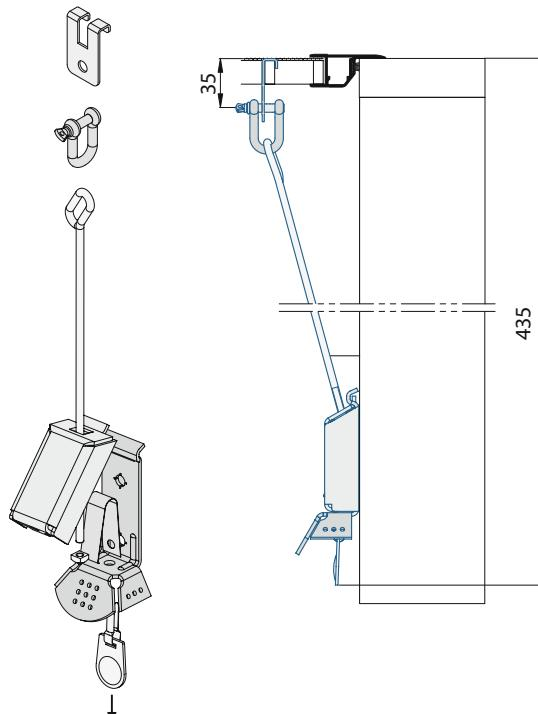
Sur demande, le recouvrement TERRESA peut également être équipé de deux étriers en inox afin de monter un autre dispositif de verrouillage de puits de lumière.
