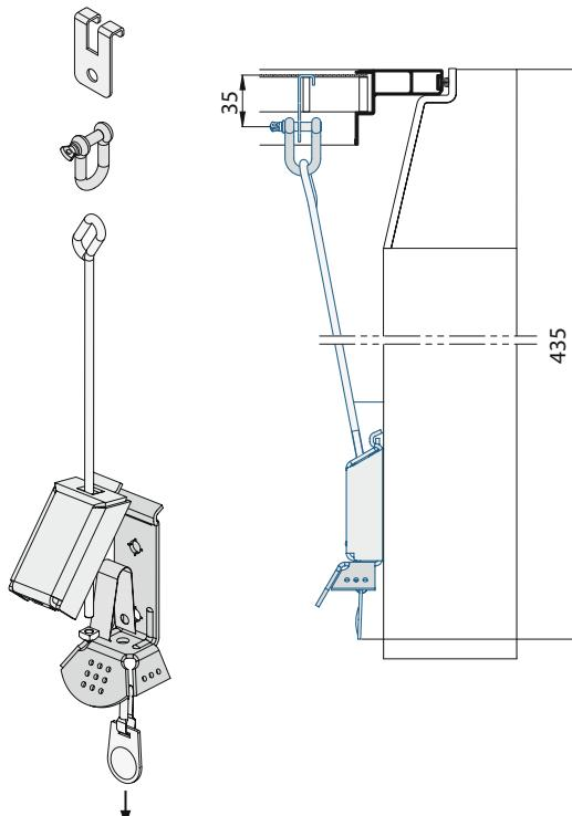
Sur demande, le recouvrement ELSA peut également être équipé de deux étriers en inox afin de monter un autre dispositif de verrouillage de puits de lumière.
