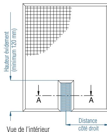
Les évidements (par ex. pour le dispositif automatique d'ouverture de fenêtre) sont étanchéifiés par un profilé en H avec brosse strip.
