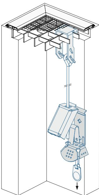
Sur demande, le puits de lumière à recouvrement intégré LiSA peut être protégé par un dispositif de verrouillage spécialement développé.
