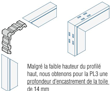
Malgré la faible hauteur du profilé haut, nous obtenons pour la PL3 une profondeur d'encastrement de la toile de 14 mm
